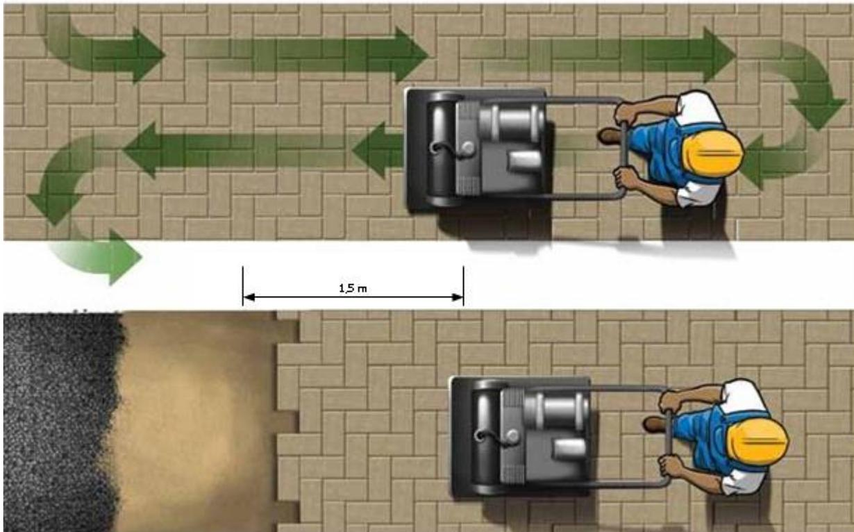
A compactação das bordas do pavimento, bem como de locais de difícil acesso às placas vibratórias (como a compactação junto a construções) deve ser realizada utilizando equipamentos de menor porte.
